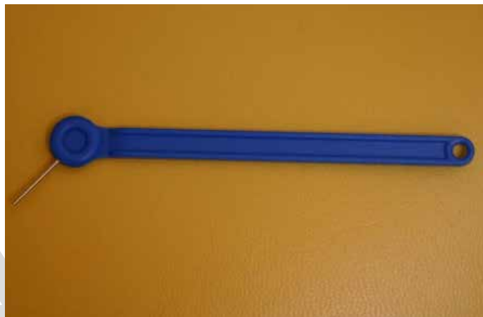
Figura 3 Chave de disjuntor em forma de espátula.
